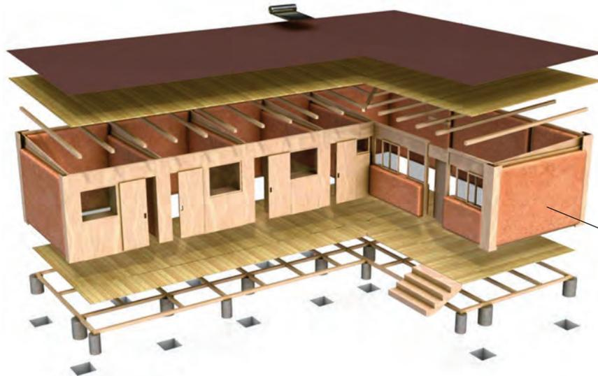
Cimentación de concreto, estructura de madera, muros interiores de pacas de paja repellados con tierra.
