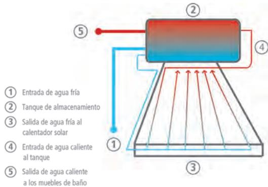
Figura EC.15 Diagrama del sistema de suministro de agua caliente con calentador solar
